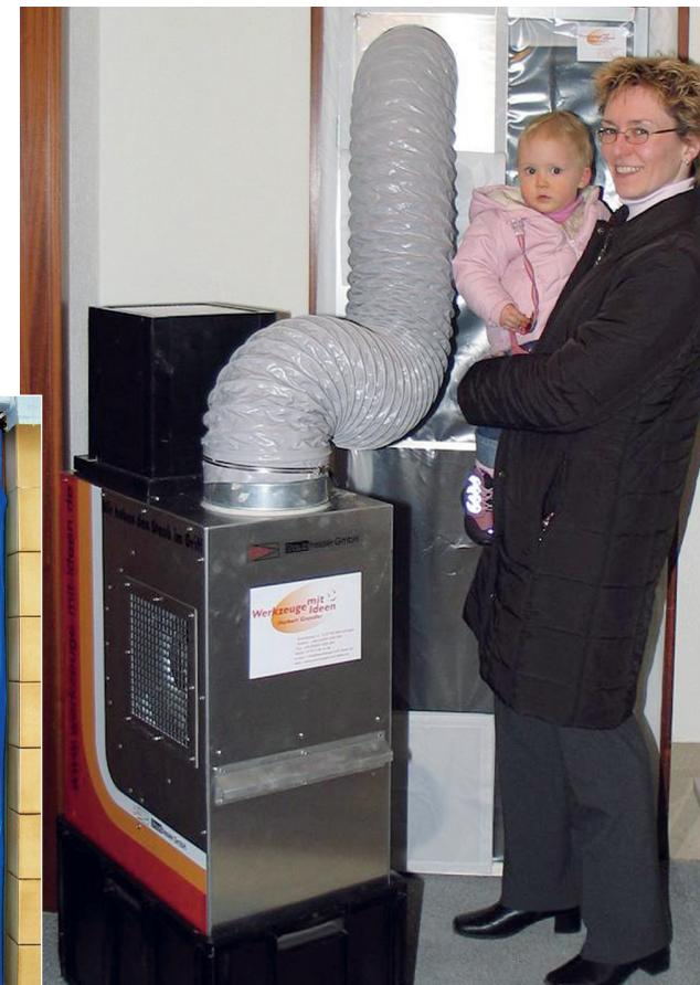
**3** Wir setzen den „**Staubfresser**“ ein: Das Gerät saugt die im Arbeitsraum entstandene staubhaltige Luft an und wäscht sie im Wassernebel aus. Durch einen zusätzlichen Partikelfilter wird auch der **Feinstaub ausgefiltert**, den das Wasser nicht binden kann.
